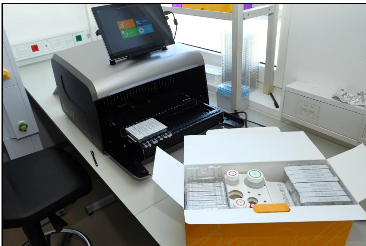
Slika 4: Kit za ekstrakciju DNK Maxwell® RSC PureFood GMO and Authentication Kit, komplementaran z aparatom za avtomatsko ekstrakciju DNK Maxwell® RSC (48) (v ozadju). / Kit za ekstrakciju DNA (Maxwell® RSC PureFood GMO and Authentication Kit), komplementaran s aparatom za automatsku ekstrakciju DNA Maxwell® RSC (48) (u pozadini).
